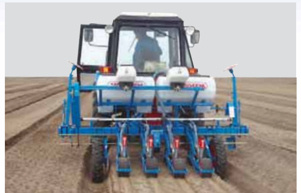
Siewnik MS A - Rama sztywne Monoblokowa - 4 rzędy, z podsiewaczem do nawozów i z aplikatorem do mikrogranulatów Microsem
