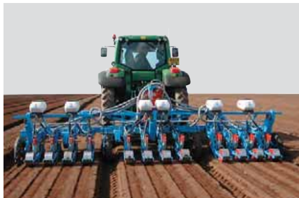
Siewnik MS C - Rama składana dwubelkowa 3 x 4 rzędy, z aplikatorem mikrogranulatów Microsem
