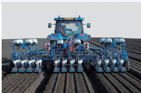
Siewnik MS D2 - Rama składana dwubelkowa 3 x 4 podwójne rzędy, z aplikatorem mikrogranulatów Microsem
