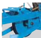
Kółko pośrednie z opasaniem elastycznym samoczyszczące
