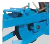
Kółko pośrednie z opasaniem elastycznym samoczyszczące (niekompatybilne z sekcją wysiewającą MS D)
