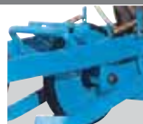
Kółko pośrednie z opasaniem elastycznym samoczyszczące
