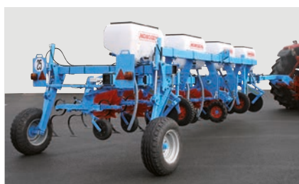
Pielnik na ramie TIP 5" – 8 rzędów o rozstawie co 70 cm w transporcie
