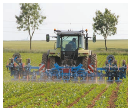
Częściowo składany pielnik o «dużej szerokości» może pielnić 8 rzędów kukurydzy lub 12 rzędów buraków. Daje to możliwość używania jednej maszyny na różnych polach, obsianych siewnikami punktowymi o różnych szerokościach roboczych!
