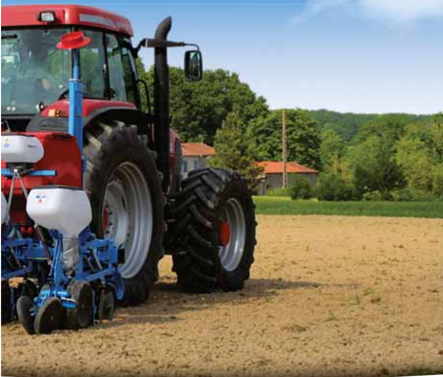
6-rzędowy siewnik na teleskopowej ramie pojedynczej monoblokowej (rozstaw między rzędami co 75 cm)
