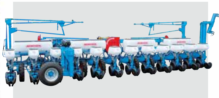
12-rzędowy siewnik na ramie łączonej (rozstaw między rzędami co 75 cm)
