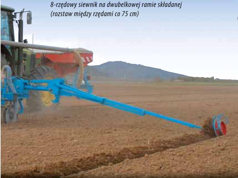
8-rzędowy siewnik na dwubelkowej ramie składanej (rozstaw między rzędami co 75 cm)
