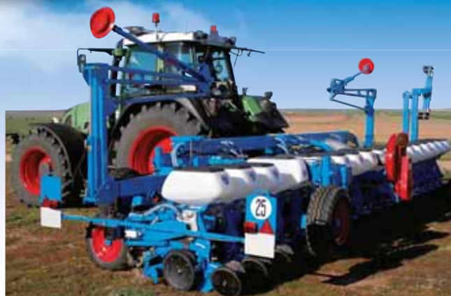
18-rzędowy siewnik na ramie łączonej (rozstaw między rzędami co 45 cm)
