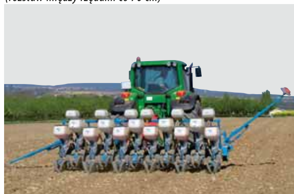
11-rzędowy siewnik na ramie sztywnej monoblokowej (37,5 cm lub 75 cm rozstawu między sekcjami wysiewającymi w przypadku siewnika 6-rzędowego)
