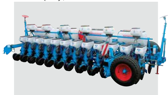
12-rzędowy siewnik na sztywnej ramie podwójnej (45 cm między sekcjami wysiewającymi), z wózkiem transportowym wbudowanym wzdłuż maszyny
