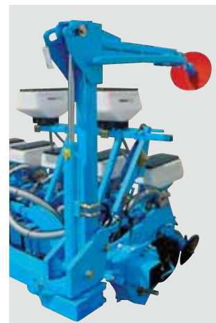
12-rzędowy siewnik na dwubelkowej ramie składanej (rozstaw między rzędami co 45 cm)
