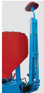
Znaczniki przejazdów składane hydraulicznie znajdują się w seryjnym wyposażeniu wszystkich siewników.
