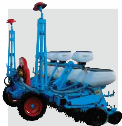
Rama monoblokowa z wysuniętym mocowaniem zaczepowym umożliwia osiągnięcie rozstawu między sekcjami 37,5 cm.
