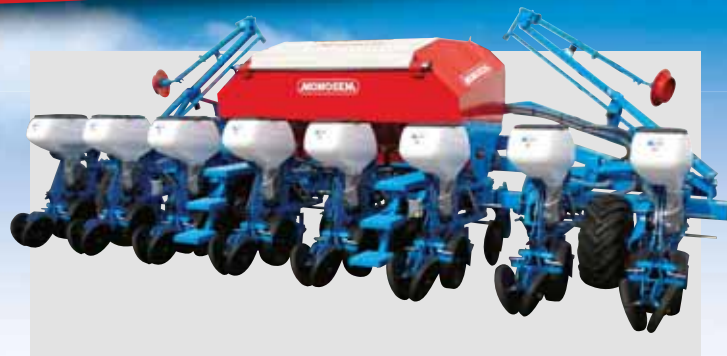
Siewnik 8-rzędowy na ramie składanej TFC typu pływającego (rozstaw co 75 cm)
