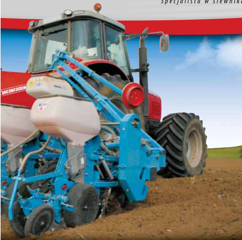
Siewnik 8-rzędowy na ramie składanej TFC typu pływającego (rozstaw co 75 cm)
