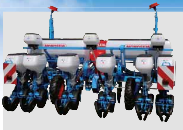
6-rzędowy siewnik na teleskopowej ramie pojedynczej monoblokowej (rozstaw między rzędami co 75 cm)
