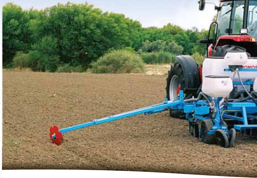
Siewnik 6-rzędowy, na ramie sztywnej monoblokowej (rozstaw między sekcjami co 90 cm)
