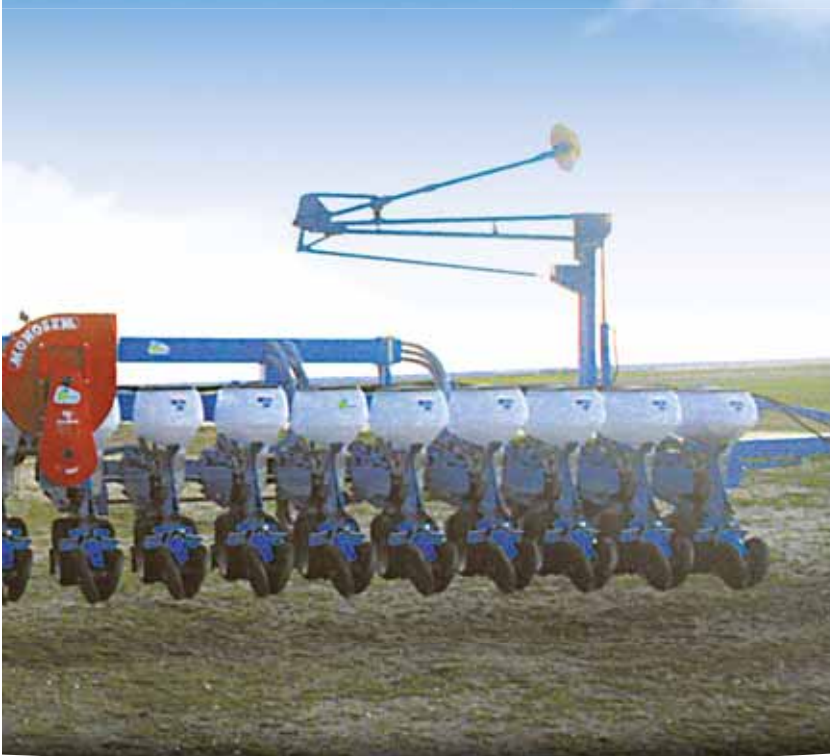
18-rzędowy siewnik na ramie łączonej (rozstaw między rzędami co 45 cm)
