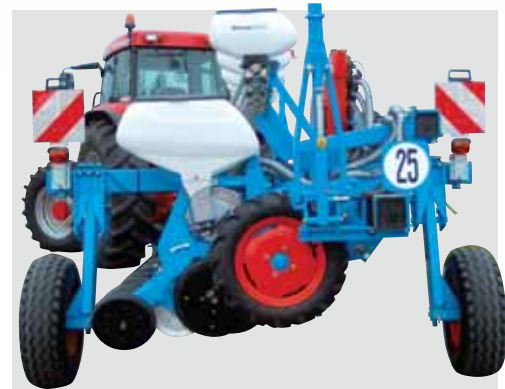
Wózek transportowy (zapewniający podłużny transport siewnika) jest możliwy w większych modelach siewników. Wózek może być podnoszony ręcznie lub hydraulicznie.
