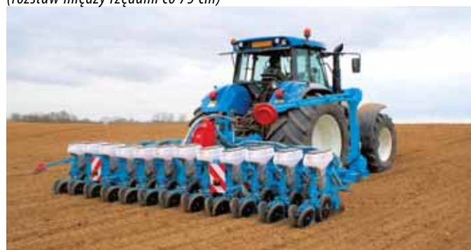
12-rzędowy siewnik na dwubelkowej ramie składanej (rozstaw między rzędami co 45 cm)
