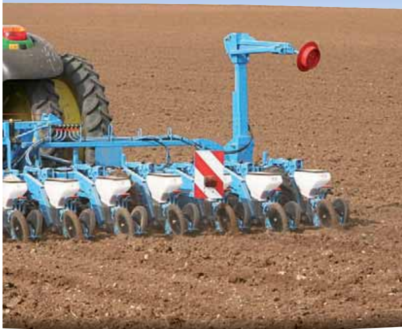
Siewnik MECA V4 na ramie składanej dwubelkowej, 12-rzędowy
