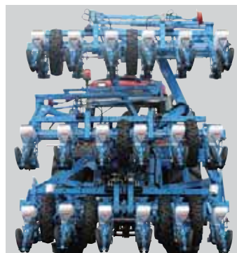
Siewnik MECA V4 na ramie składanej trzypoziomowej, 18-rzędowy, w pozycji transportowej
