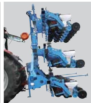
Siewnik MECA V4 na ramie składanej trzypoziomowej, 18-rzędowy, w pozycji transportowej
