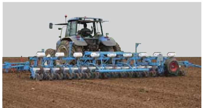
Siewnik MECA V4 na ramie sztywnej trzybelkowej, 18-rzędowy, z aplikatorem Microsem, z wózkiem transportowym
