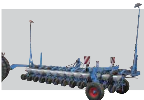
Siewnik MECA V4 na ramie sztywnej trzybelkowej, 12-rzędowy, na wózku transportowym
