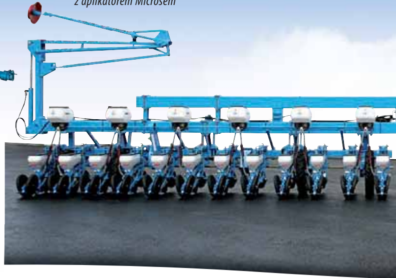
Siewnik MECA V4 na ramie łączonej, 24-rzędowy, z aplikatorem Microsem
