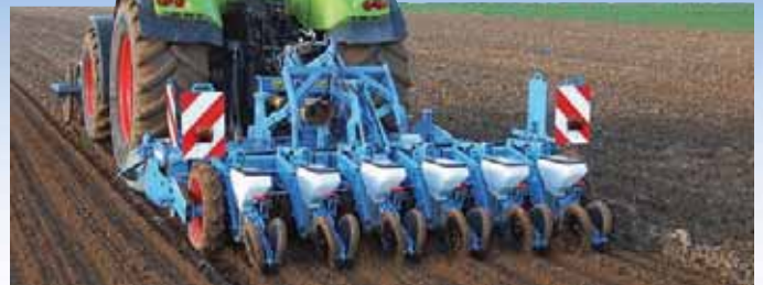
Siewnik MECA V4 na ramie sztywnej jednobelkowej, 6-rzędowy
