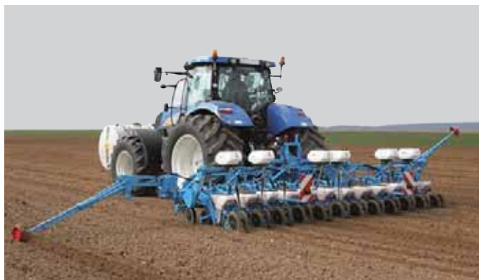
Siewnik MECA V4 na ramie składanej dwubelkowej, 12-rzędowy, z aplikatorem Microsem
