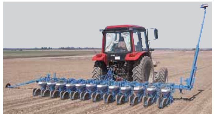
Siewnik MECA V4 na ramie sztywnej jednobelkowej, 12-rzędowy
