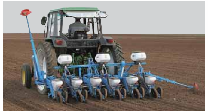
Siewnik MECA V4 na ramie sztywnej jednobelkowej, 6-rzędowy, z aplikatorem Microsem
