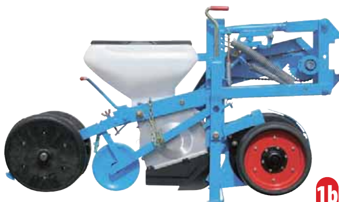
Sekcja wysiewająca MECA V4 Koło przednie 285x65 + Kroje talerzowe z dwoma bocznymi kołami – Koło kopiujące
