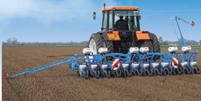
Siewnik MECA V4 na ramie składanej kompaktowej, 12-rzędowy, z aplikatorem Microsem
