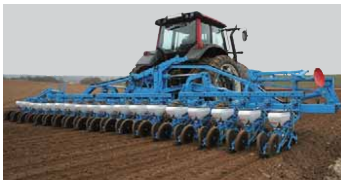
Siewnik MECA V4 na ramie składanej trzypoziomowej, 18-rzędowy
