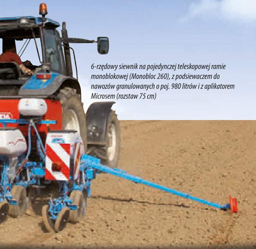
Siewnik 6-rzędowy na ramie teleskopowej pojedynczej Monobloc 260, z aplikatorem Microsem kombinowanym (rozstaw między rzędami 75 cm).
