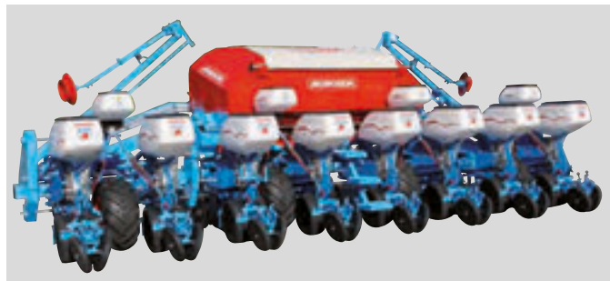
Siewnik 8-rzędowy na ramie składanej TFC «pływającej» (rozstaw między rzędami 75 cm)
