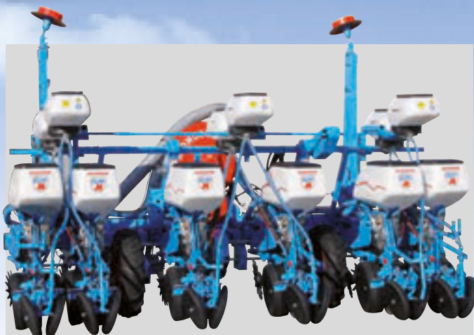
Siewnik 6-rzędowy na ramie teleskopowej pojedynczej Monobloc 260, z aplikatorem Microsem kombinowanym (rozstaw między rzędami 75 cm).
