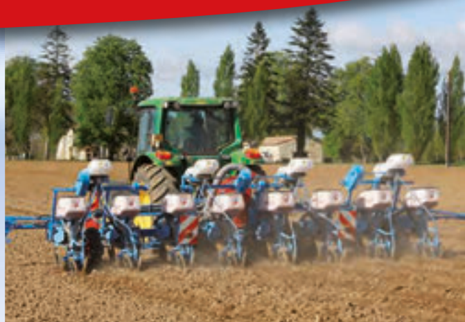
Siewnik 8-rzędowy na ramie składanej dwubelkowej (rozstaw między rzędami 80 cm)
