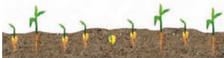
Wysiew na dużej prędkości roboczej bez Monoshox® Wysiew ziarna i głębokość wysiewu nie są równomierne, przez co wschody nie są równe.
