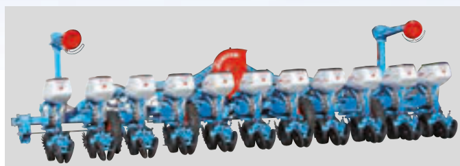
Siewnik 11-rzędowy na ramie składanej dwubelkowej (rozstaw między rzędami 60 cm)
