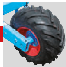
Wzmocniony blok koła z ogumieniem 26x12
