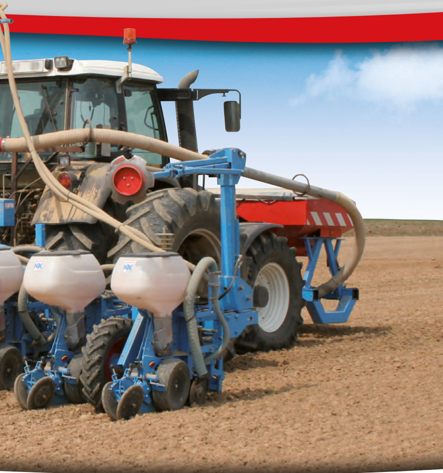
Siewnik 6-rzędowy na ramie składanej (rozstaw między rzędami co 75 cm)
