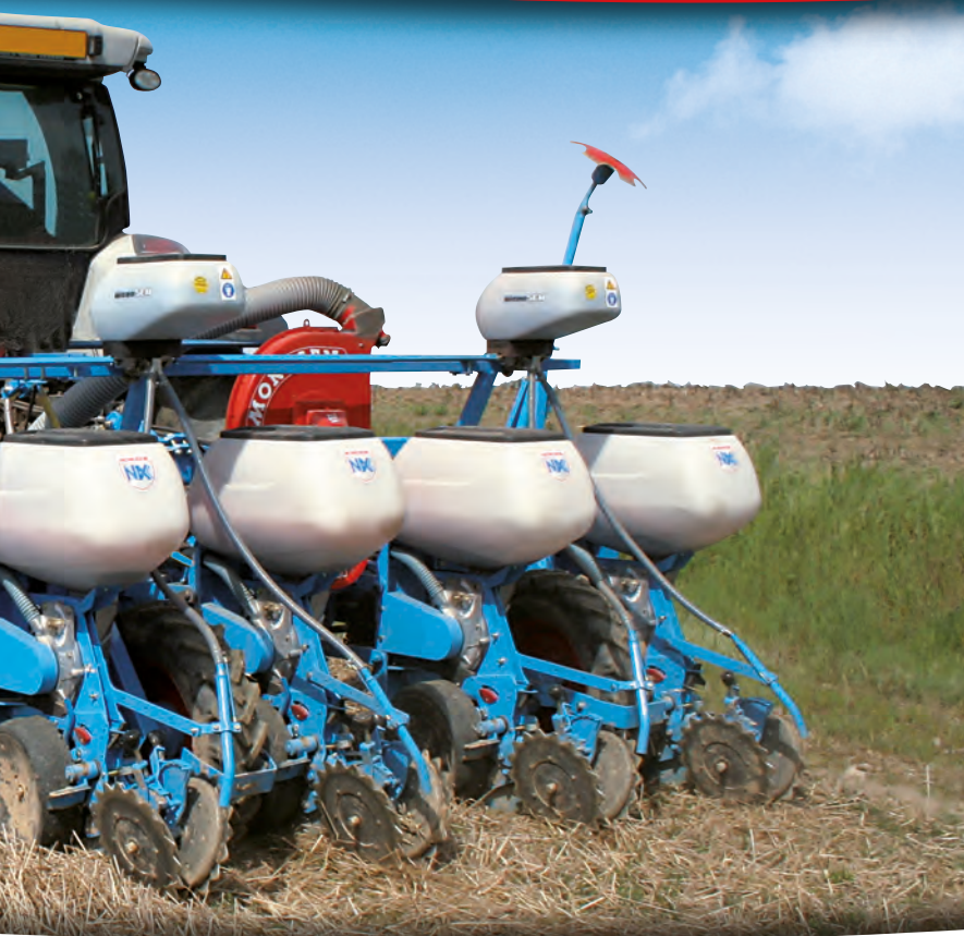
Siewnik 4-rzędowy z podsiewaczem (rozstaw między rzędami co 75 cm)
