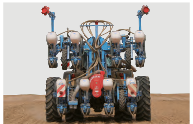
Siewnik 8-rzędowy na ramie składanej w pozycji transportowej
