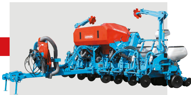
Podsiewacz o poj. 1500 litrów siewnika 8-rzędowego na ramie składanej WingFold
