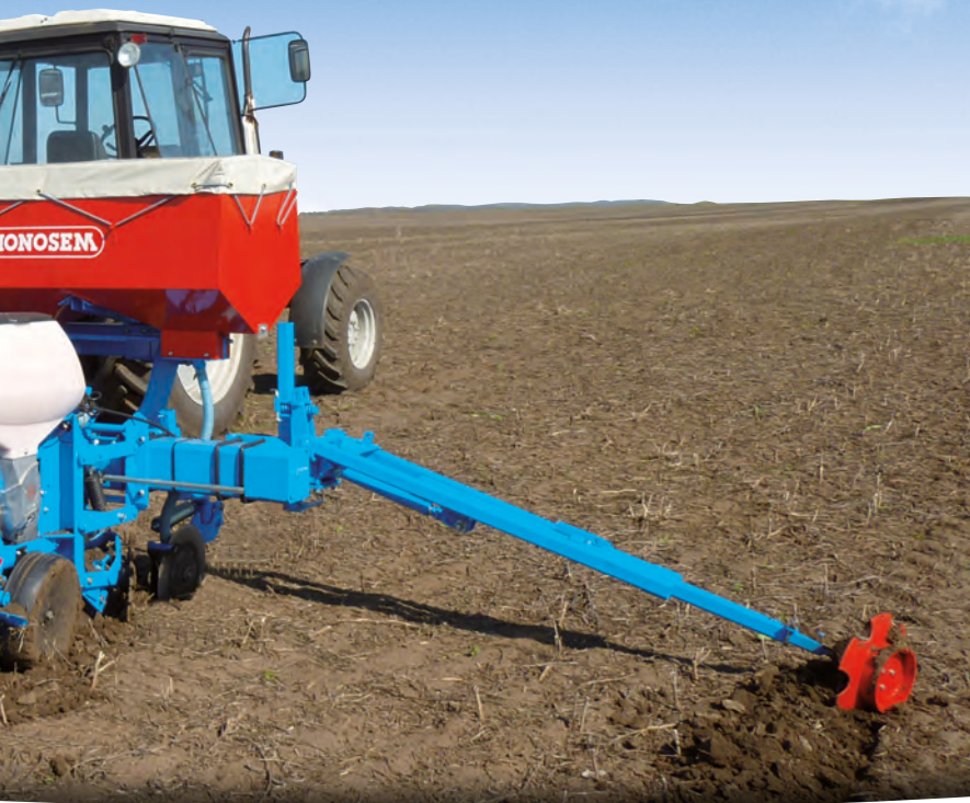
Siewnik na ramie przyczepianej, 6-rzędowy, z podsiewaczem (rozstaw między rzędami co 75 cm)
