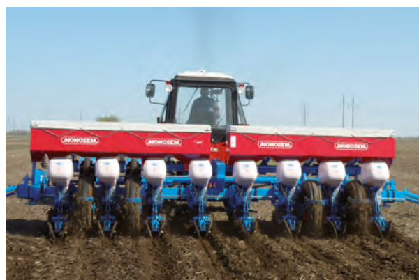
Siewnik na ramie przyczepianej, 8-rzędowy, z podsiewaczem (rozstaw między rzędami co 70 cm)
