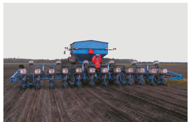
Siewnik 12-rzędowy na ramie składanej (rozstaw między rzędami co 75 cm)
