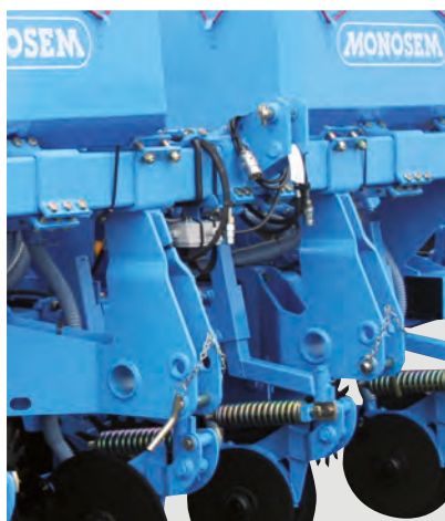
Zaczep siewnika na ramie sztywnej podwójnej (dwubelkowej)
