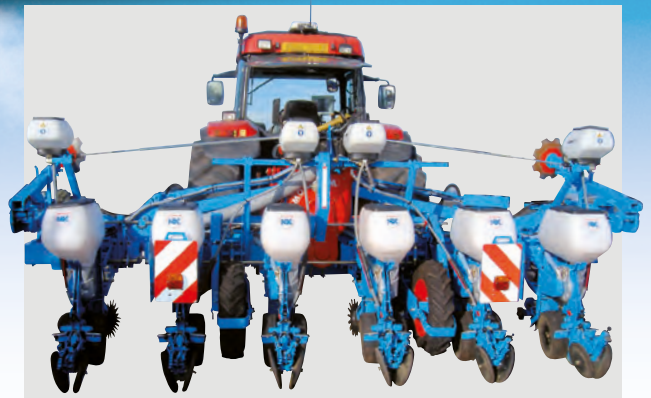
Siewnik 6-rzędowy na ramie składanej (rozstaw między rzędami co 75 cm)
