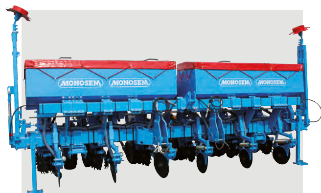
Siewnik 6-rzędowy z podsiewaczem (rozstaw między rzędami co 75 cm)
