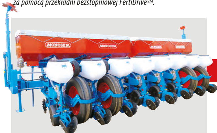
Podsiewacz ze zbiornikami 2 x 1000 litrów siewnika 8-rzędowego na ramie przyczepianej
