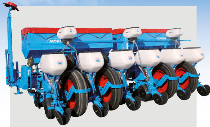
Siewnik na ramie przyczepianej, 6-rzędowy, z podsiewaczem (rozstaw między rzędami co 75 cm)
