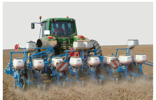
Siewnik 8-rzędowy na ramie składanej (rozstaw między rzędami co 80 cm)
