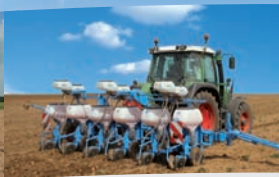
Specjalny, pneumatyczny, talerzowy siewnik do siewu uproszczonego NX2
