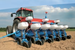
Uniwersalny pneumatyczny, talerzowy siewnik punktowy, NG Plus 4
