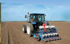
Siewniki do warzyw, specjalne do wysiewu drobnych nasion, MS
