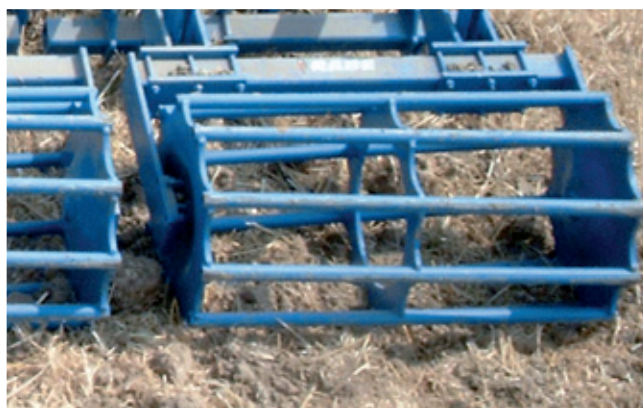
Wał rurowy (śr. 54 cm) z zakrzywionymi talerzami (235 kg/m) przed wałem lub alternatywnie zęby wyrównujące (223 kg/m).
