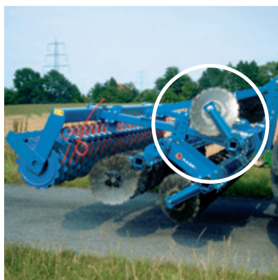
Zawieszana brona kompaktowa z niezależnymi talerzami Field Bird 3000 E, szerokość robocza i transportowa 3 m.
