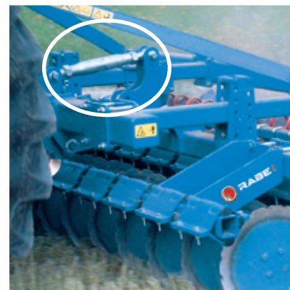
Ustawianie głębokości pracy pierwszego i drugiego rzędu za pomocą napinaczy.
