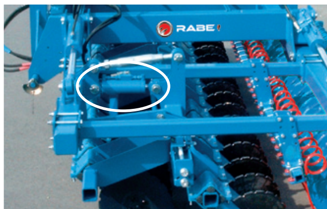
Field Bird 4000 EK Hydrauliczna regulacja głębokości roboczej.
