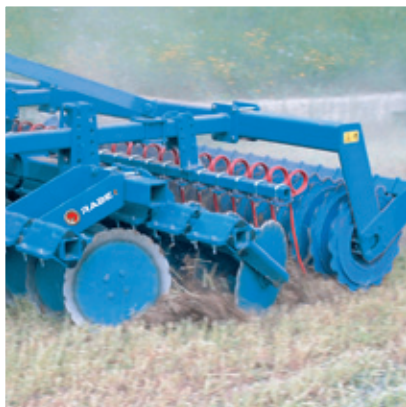
Karbowane, ustawione pod kątem talerze wykonują agresywną pracę i intensywne mieszanie ziemi z resztkami roślinnymi (mulczem).
