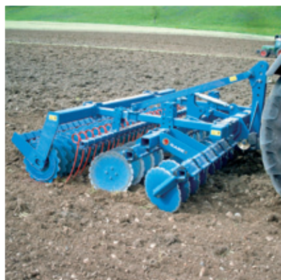
Zawieszana brona kompaktowa z niezależnymi talerzami Field Bird 3000 E, szerokość robocza i transportowa 3 m.
