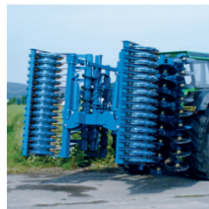
Zawieszana brona kompaktowa z niezależnymi talerzami Field Bird 4000 EK, hydraulicznie składana do szerokości transportowej 3 m.
