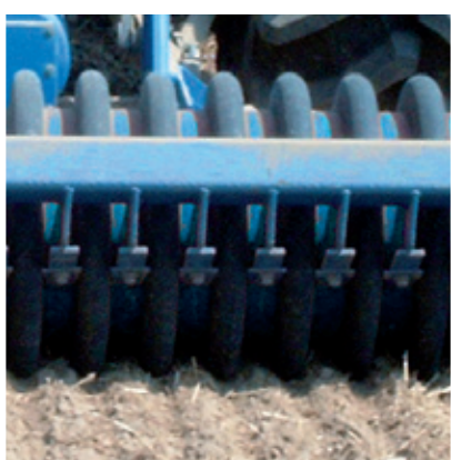
Wał bruzdowy pierścieniowy (śr. 58 cm) dla równomiernego ugniatania gleby na całej szerokości roboczej.
