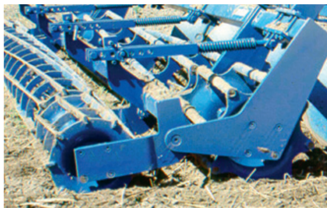
Tandemowy wał tylny = wał rurowy (śr. 44 cm) i kruszący (śr. 35 cm) z zębami wyrównującymi (253 kg/m) przed wałem lub alternatywnie z zakrzywionymi talerzami 241 kg/m).
