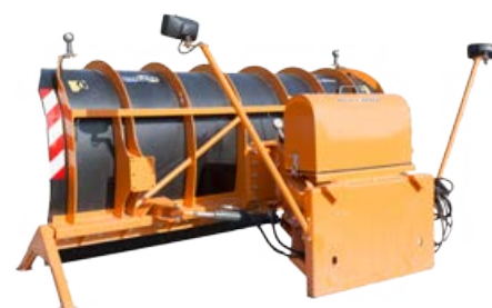
Własny niezależny układ hydrauliczny (POLI H)
