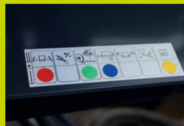
Oznaczenie kolorami przewodów hydraulicznych
