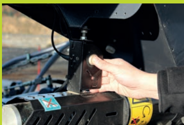
Przycisk uruchamiający próbę kręconą Umieszczony obok dozownika ziarna
