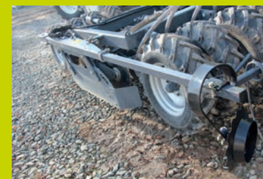
Znaczniki przejazdów z zabezpieczeniem sprężynowym
