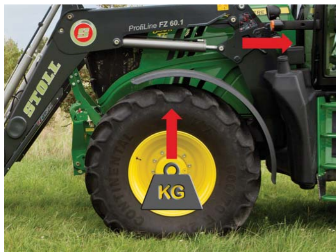
Mocowania leżą blisko kabiny kierowcy – to odciąża przednią oś ciągnika.
