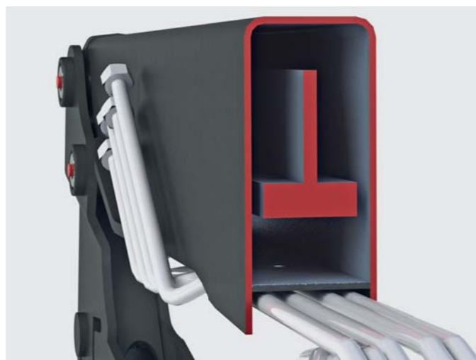
Przekrój poprzeczny przez dźwigar wahacza – wewnątrz usytuowany jest drążek sterujący, a poniżej leżą przewody hydrauliczne.
