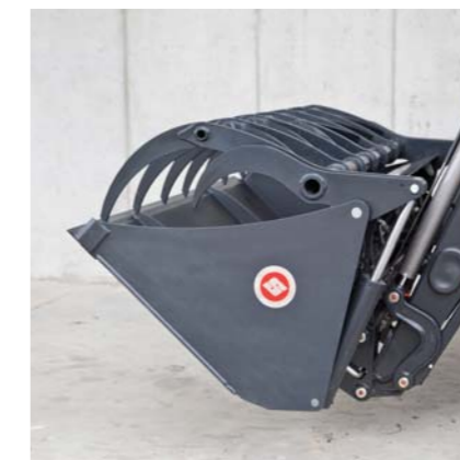
2 Przechylić narzędzie – ryglowanie zatraskuje się automatycznie
