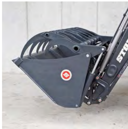
2 Przechylić narzędzie – ryglowanie zatrzaskuje się automatycznie
