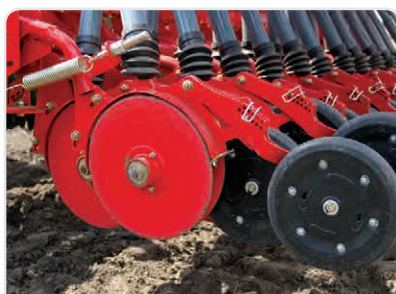
Kółka dociskowe umieszczone za redlicami pozwalają uzyskać wysoką równomierność wschodów.
