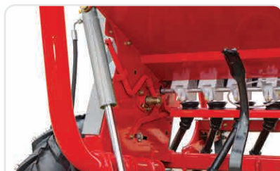
Znaczniki przejazdów na układzie podwójnych siłowników.
