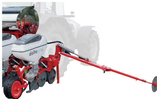
DELTA K4 ma dwa zbiorniki nawozowe o pojemności 200 l każdy.
