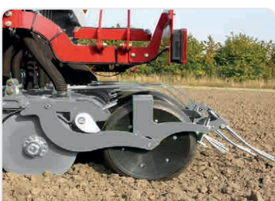
Redlica ciężka – posiada w wyposażeniu standardowym szerokie koło zagęszczające glebę wokół nasiona. Łatwa regulacja głębokości ogranicza zagłębianie redlic nawet na glebie mozaikowej.
