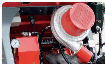
Wentylator napędzany jest silnikiem hydraulicznym o przepływie 24 l/min.
