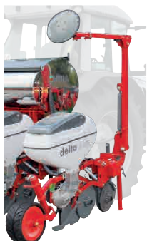
Znaczniki przejazdów składane w połowie pozwalają na transport maszyny nawet pod niskimi przeszkodami.
