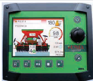
SUPERIOR to elektroniczna kontrola siewu i sterowanie siewnikiem. Ten panel jest kompatybilny z innymi maszynami UNIA.
