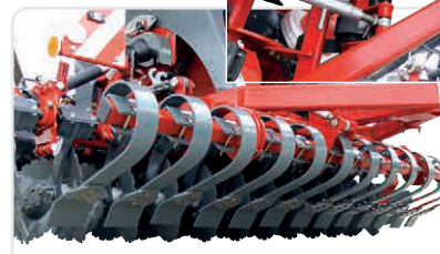
Włoka przednia w technologii orkowej dokładnie wyrównuje powierzchnię przed talerzami doprawiającymi, co ułatwia zagęszczenie przedsiewne. Łatwa regulacja agresywności pracy za pomocą śrub rzymskich.
