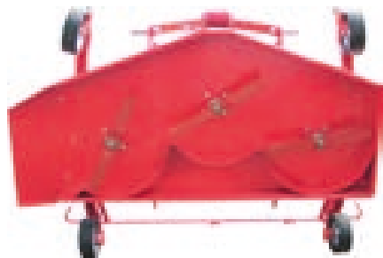
Trzy noże tnące rozdrabniają trawę i odrzucają ją do tyłu lub do boku.
