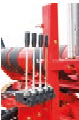
Gucio H – wersja z rozdzielaczem mechanicznym
