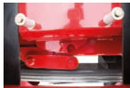
Blokada mechaniczna stołu – stabilizuje stół przy dojazdach oraz transporcie
