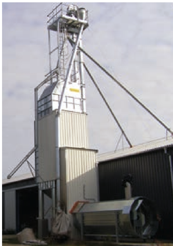
Suszarnia z ociepleniem i piecem z wymiennikiem ciepła.
