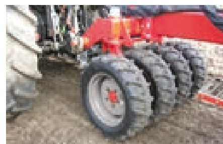
Przedni Packer zaczepy (skrętne) ø800 mm
