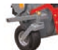
Skrętne koła kopiujące – zwiększają komfort pracy na uwrociach.
