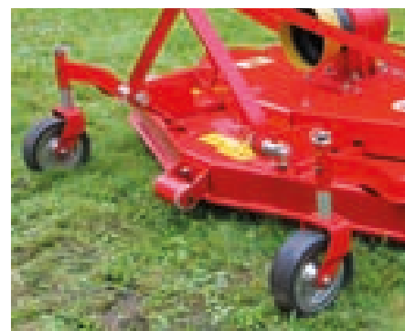
Do regulacji wysokości cięcia służą koła podporowe.
