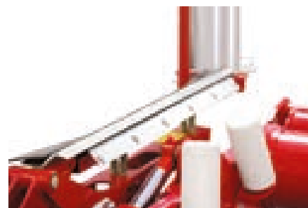
Nóż – odcina folię oraz przytrzymuje ją do następnego owijania
