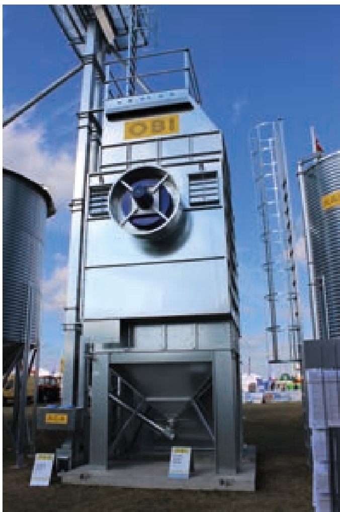
Suszarnia z ociepleniem i piecem z wymiennikiem ciepła.
