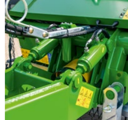
Wysokość zaczepu można łatwo regulować.
