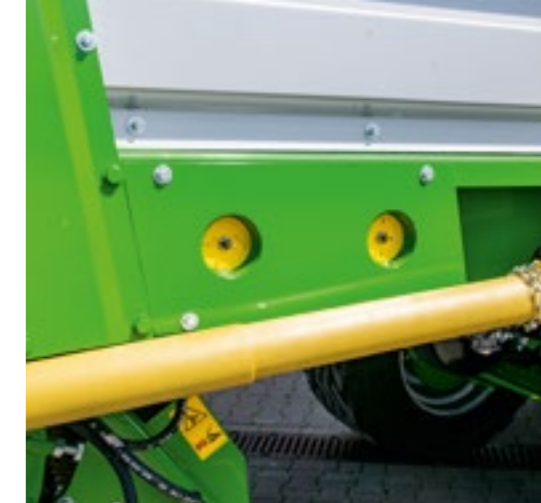
Komfortowe nastawianie dyszla i belki nożowej odbywa się po lewej stronie pojazdu.
