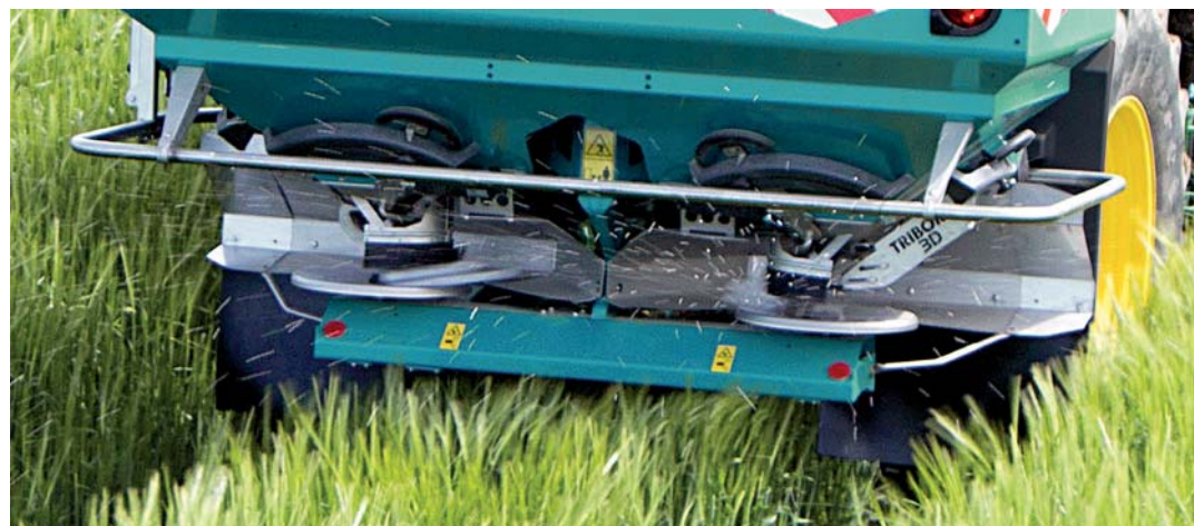
Hartowane łopatki rozsiewające o dużej odporności w wyposażeniu seryjnym we wszystkich modelach X50+ oraz w modelach X40+ W, X40+ W Stop&Go i X40+ ECONOV
