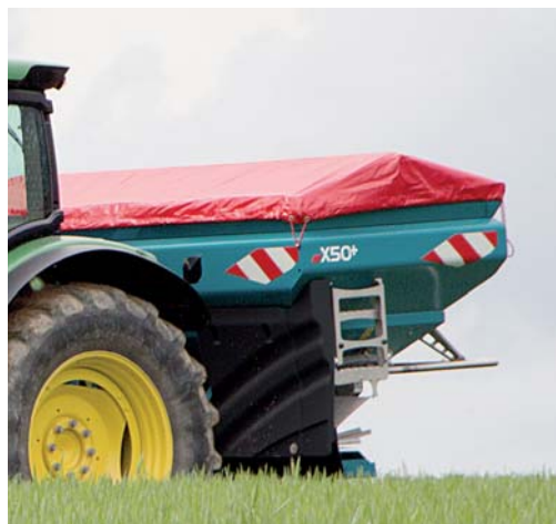
Oslony z odpornego kompozytu (seryjnie) i elastyczne błotniki (opcja) : całkowita ochrona przed odrzucaną glebą podczas rozsiewu na dużej prędkości roboczej w wilgotnych warunkach oraz łatwiejsze czyszczenie maszyny
