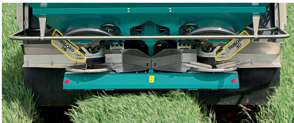
Rozsiew graniczny TRIBORD 3D dostępny po prawej stronie (seryjnie) i po lewej stronie (opcja możliwa w wersji ISOBUS).
